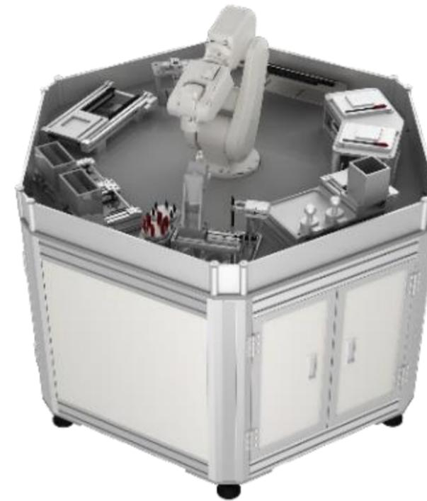
该实训装置属于典型的机器人基础技能培训应用设备，以六自由度机器人中心，根据任务要求配置不同任务载体，培养学生对机器人基础知识的认知。该设备任务载体采用模块化设计，具备独立性、兼容性、可移植性等特点；并预留了扩展与升级的接口，根据市场需求进行不断的开发升级或者学校用户自行创新设计新的功能模块。
