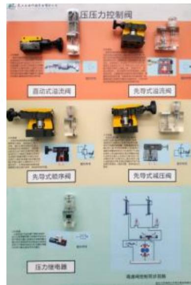
挂板2 液压压力控制阀
