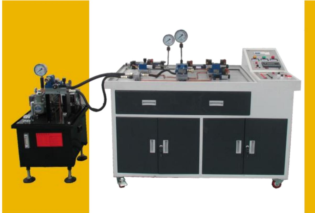
JL -YZAT - 1型液压安装调试实训装置由实训操作平台、 电器控制单元、集成液压阀组、液压泵站、导线架等组成，全模块开放式结构设计，并配有强大的扩展功能。本装置采用工业液压阀及工业标准管材、接头，以液压传动典型回路系统为对象，培养学生液压管路和液压元件的装拆与替换、硬管制作、液压回路系统调试等基本技能。适合职业院校相关专业“液压传动”“液压与气压传动”等课程的实训教学。
