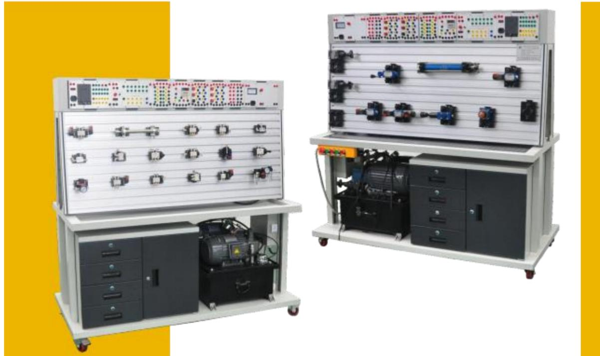
JL - SQY -02A型 双面液压气动实验台覆盖了气压传动、液压传动、传动继电器控制、PLC自动控制、传感器应用技术等多个技术领域。是气压传动技术、液压传动技术和各种现代控制技术的组合体。加上该实验采用双面工作台结构设计，一个实验台可供两组学生同时进行各自不同的实验，大大的提高了实验设备的使用效率，并有效的利用了实验室空间。此外，该装置采用PLC控制和继电器两种控制方式控制，可实现回路自动、气动/液动、手动等多种方式操控。
