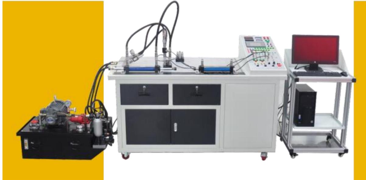
JL -YF -A该实验台依据高等院校、高等职业院校的《液压传动与控制》、《液压比例传动与控制》、《液压伺服传动与控制》等液压类教材，充分结合目前国内工业中流行的液压伺服控制技术而专门设计。实验台能充分满足教学需求、学生实践与培训需求、科研辅助需求等，从基础到高端、从教学到科研而专业设计的液压伺服控制实验台。
