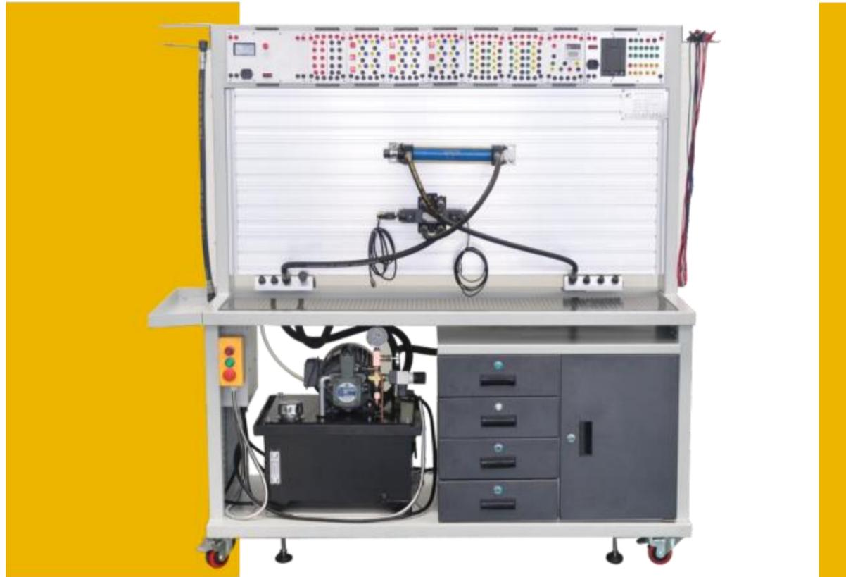
基本液压传动综合实验台由实验操作平台、电器控制平台、辅助实验设备、电脑桌等组成，全模块开放式结构设计，并配有强大的扩展功能，可以帮助学生很好的完成基本液压传动与流体力学相关基础性实验。开放式的接口可帮助学生完成液压传动的设计创新等综合性实验。此实验台能充分满足教学需求、学生实践与培训需求、科研辅助需求等，从基础到高端、从教学到科研而专业设计的液压教学实验台。
